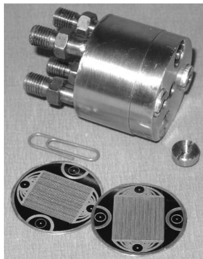
Рис. 16. Микрореактор теплообменного типа для паровой конверсии метанола. 89
