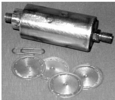
Рис. 14. Микрореактор цилиндрической формы для паровой конверсии метанола с встроенным испарителем жидкой водометанольной смеси и микрокаталитические пластины. 89
